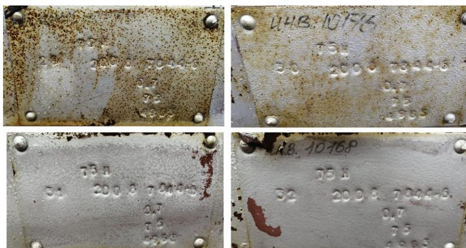
Рисунок 3 – Место нанесения заводских номеров
