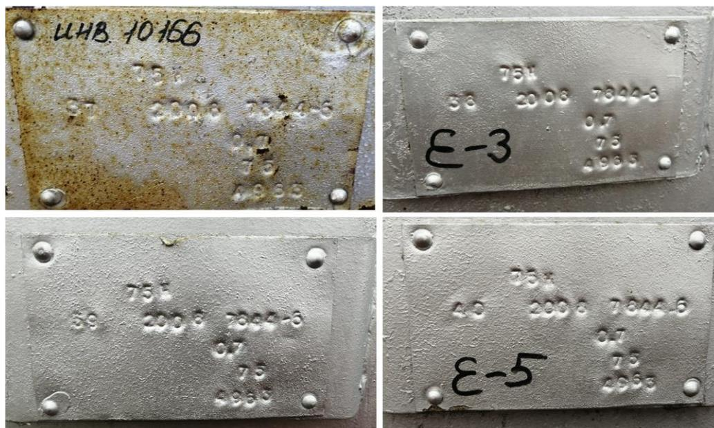
Рисунок 5 – Место нанесения заводских номеров
