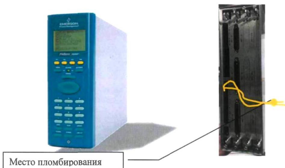
Рисунок 1 – Общий вид контроллера и схема пломбировки от несанкционированного доступа
