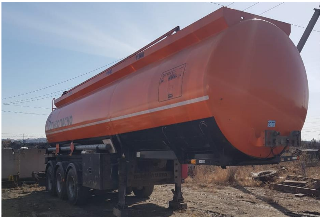
Рисунок 1 – Общий вид полуприцепа-цистерны для жидких нефтепродуктов ALI RIZA USTA
