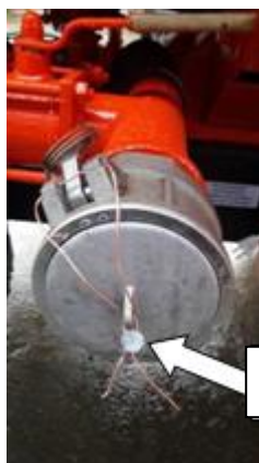
Рисунок 2 – Пломбировка трубопровода слива-налива
