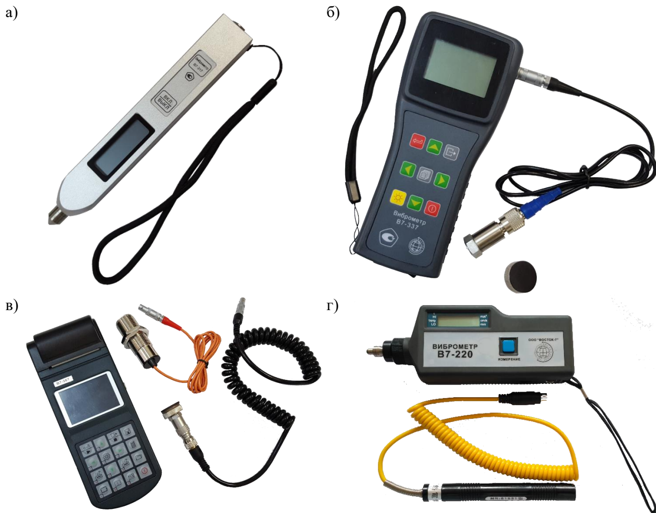
Рисунок 1 – Общий вид виброметров а) модификации В7-317, В7-327; б) модификация В7-337; в) В7-357; г) В7-220
