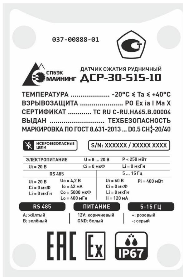
Рисунок 2- Маркировка датчиков
