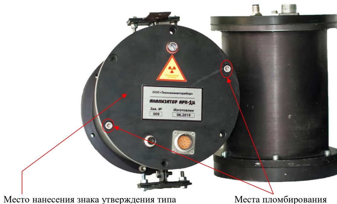
Рисунок 1 - Общий вид средства измерений, место нанесения знака утверждения типа и схема пломбирования от несанкционированного доступа
