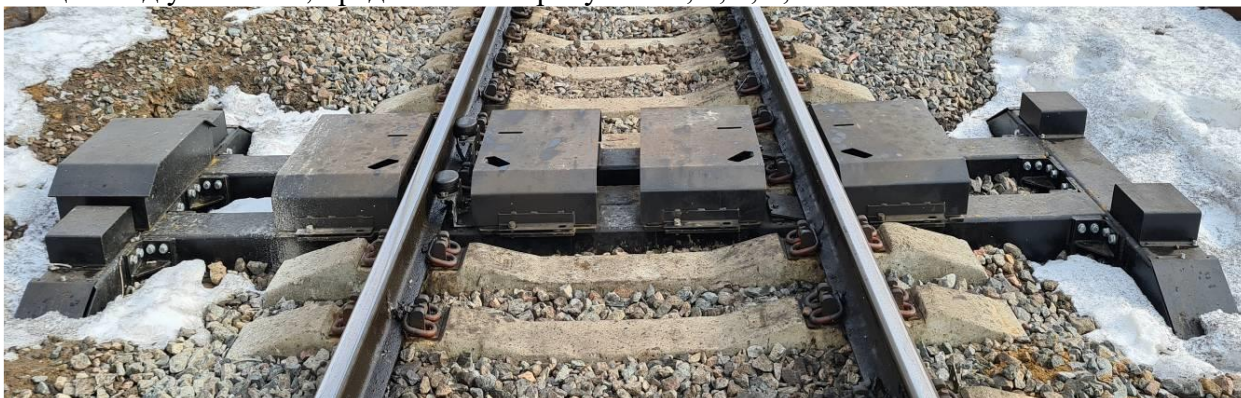
Рисунок 1 – Общий вид установок автоматизированного бесконтактного измерения геометрических параметров подвагонного пространства «ГЕПАРД»
