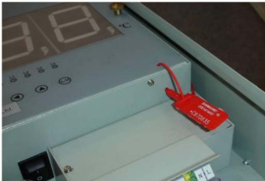
Рисунок 7 – Схема пломбирования системы непрерывного измерения температуры расплавов металлов НФС-IV
