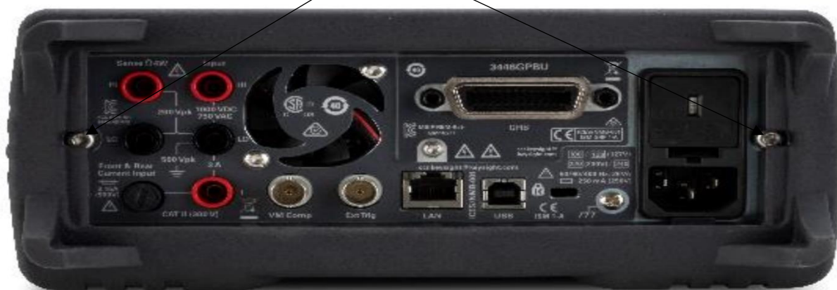
Рисунок 3 - Вид сзади на мультиметры цифровые 34465А и 34470А и схема пломбировки от несанкционированного доступа
