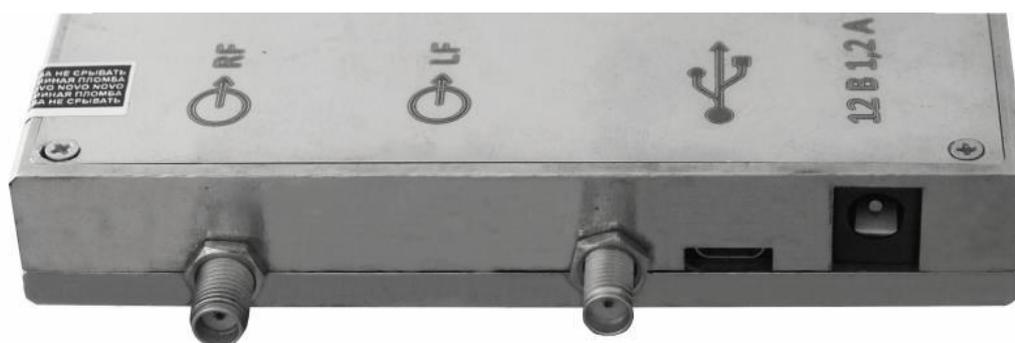
Рисунок 3 – Вид задней панели генератора
