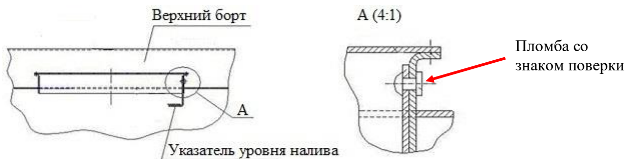
Рисунок 2 – Схема пломбировки от несанкционированного доступа, обозначение места нанесения знака поверки
