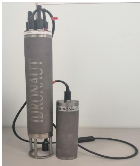
Рисунок 1– Общий вид зондов гидрологических OCEAN SEVEN модификаций 316Plus, 320Plus с аккумуляторной батареей
