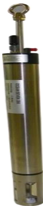
Рисунок 2– Общий вид зондов гидрологических OCEAN SEVEN модификации 304Plus
