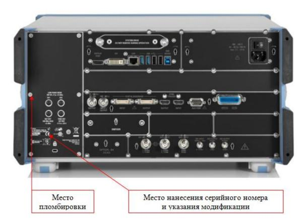
Рисунок 2- Схема пломбировки от несанкционированного доступа и место нанесения серийного номера и указания модификации СИ
