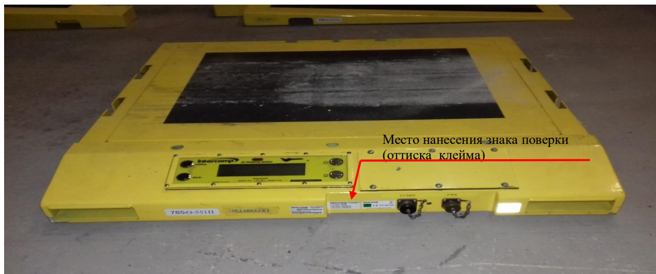
Рисунок 1 – Общий вид весов платформенных АС30-60 и место нанесения знака поверки
