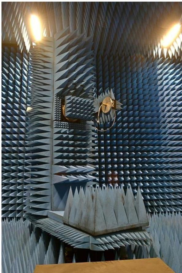
Рисунок 2 – Общий вид 4-х координатного ОПУ
