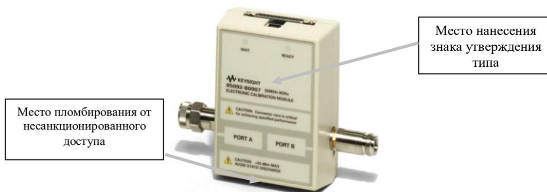
Рисунок 1 - Внешний вид модулей электронной калибровки модификаций 85092С, 85093С
