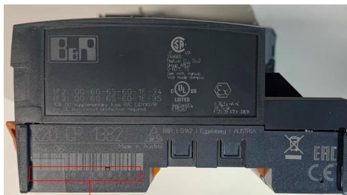
Рисунок 2 – Маркировка ЦПУ знаком ЕАС, указание серийного номера ЦПУ
