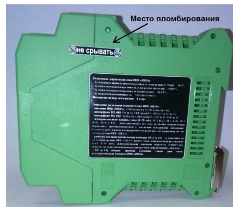
Рисунок 2 – Схема пломбировки ИВК
