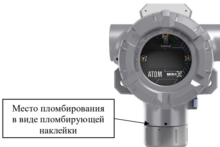
в) корпус из неокрашенной нержавеющей стали Рисунок 1 – Общий вид газоанализаторов стационарных АТОМ, а также место и метод пломбирования от несанкционированного доступа
