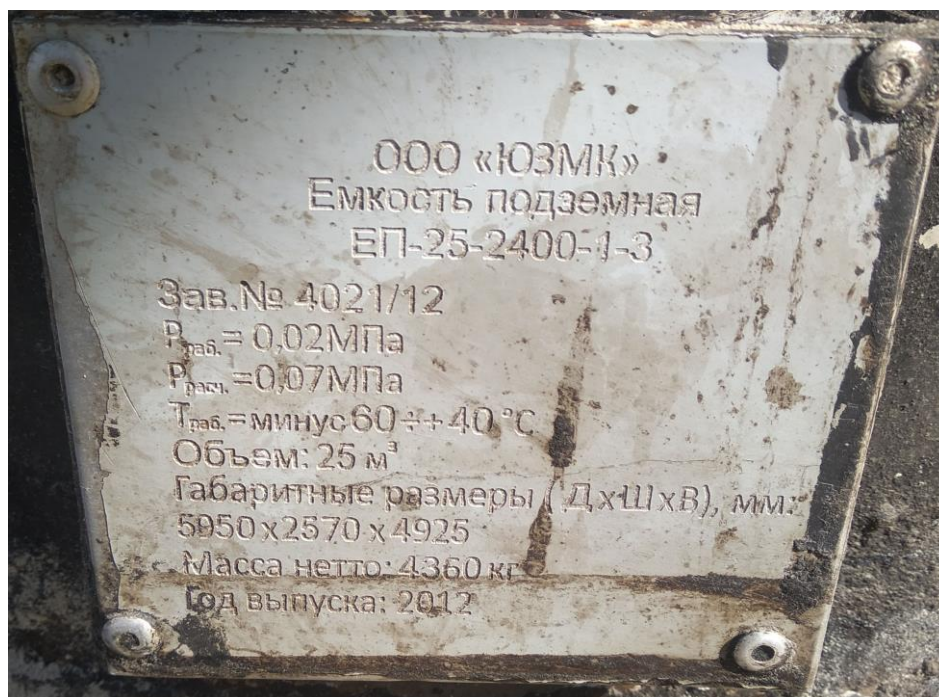
Рисунок 1 – Место и способ нанесения заводского номера
