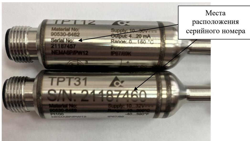
Рисунок 4 – Места расположения серийного номера
