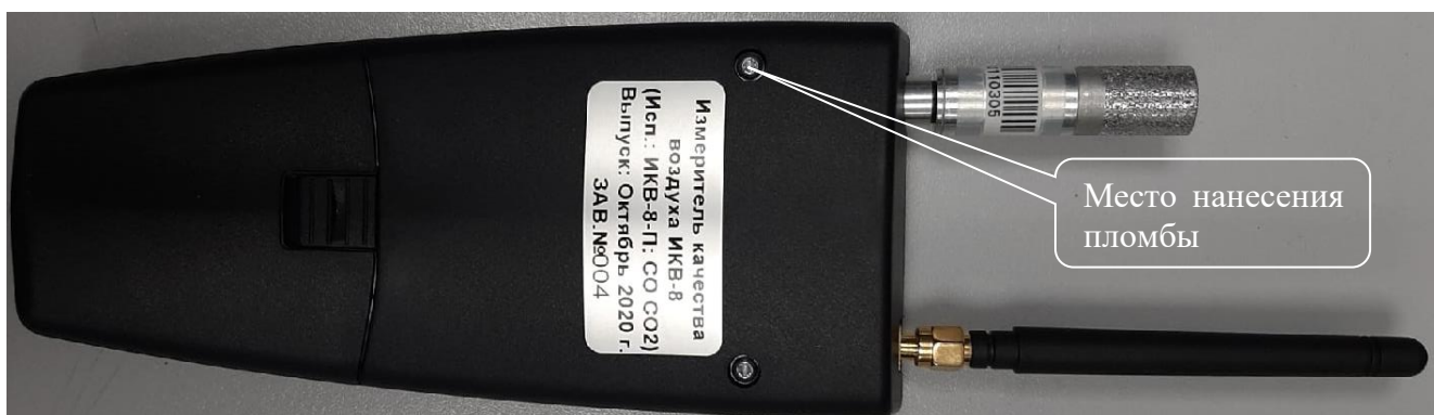
Рисунок 2 – Общий вид таблички с маркировкой измерителей и схема пломбирования от несанкционированного доступа (место пломбирования)
