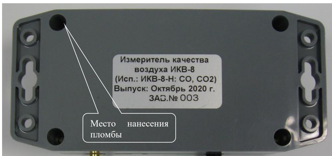
Рисунок 1 - Общий вид измерителей, схема пломбирования от несанкционированного доступа (места пломбирования) и знак утверждения типа
