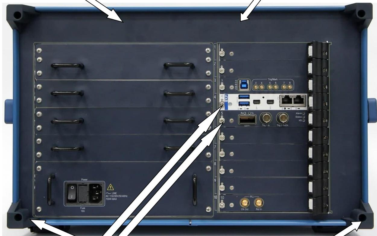
Места пломбирования от несанкционированного доступа
