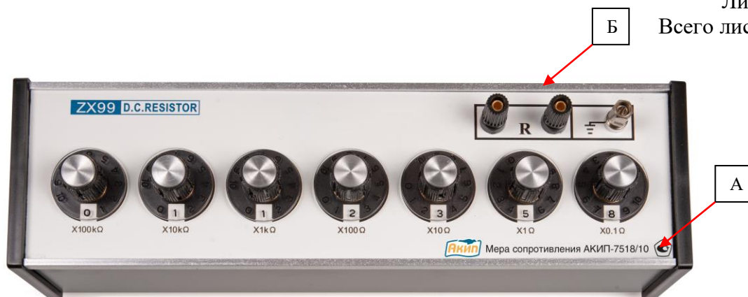
Рисунок 7 – Общий вид мер АКИП-7518/10, места нанесения знака утверждения типа (А) и знака поверки (Б)
