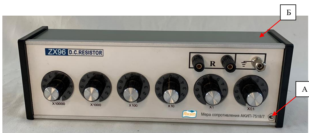
Рисунок 5 – Общий вид мер АКПП-7518/7, АКПП-7518/8, места нанесения знака утверждения типа (А) и знака поверки (Б)
