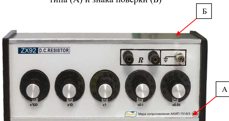
Рисунок 2 – Общий вид мер АКИП-7518/1, АКИП-7518/2, места нанесения знака утверждения типа (А) и знака поверки (Б)
