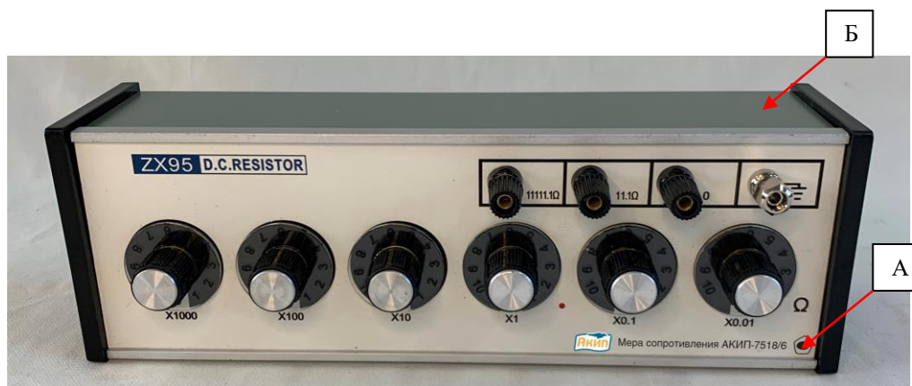
Рисунок 4 – Общий вид мер АКПП-7518/6, места нанесения знака утверждения типа (А) и знака поверки (Б)
