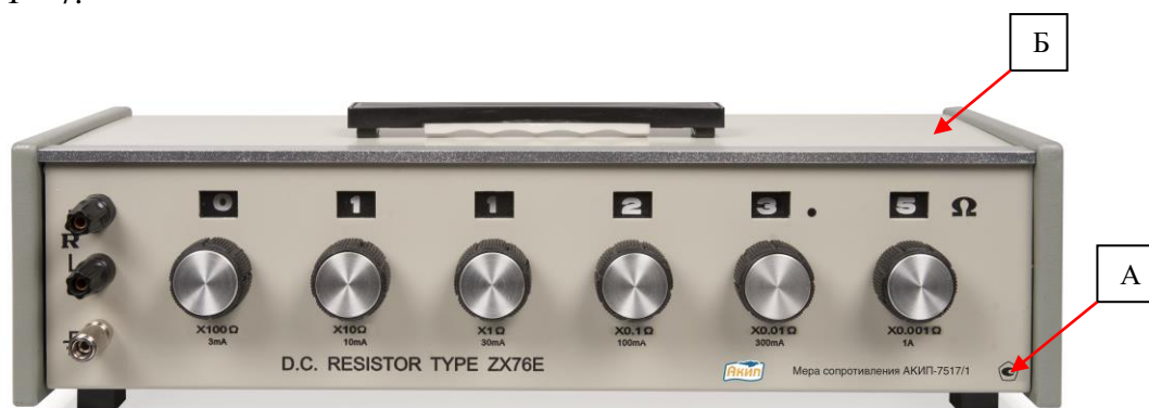
Рисунок 1 – Общий вид мер АКИП-7517, места нанесения знака утверждения типа (А) и знака поверки (Б)
