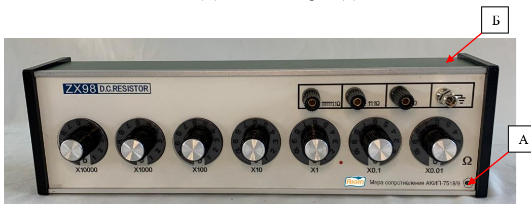
Рисунок 5 – Общий вид мер АКПП-7518/7, АКПП-7518/8, места нанесения знака утверждения типа (А) и знака поверки (Б)
