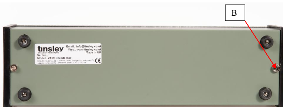
Рисунок 9 – Общий вид задней панели мер АКИП-7518 и схема пломбировки от несанкционированного доступа
