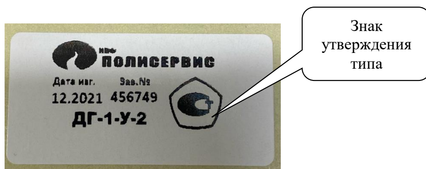
Рисунок 5 - Общий вид таблички с маркировкой сигнализатора
