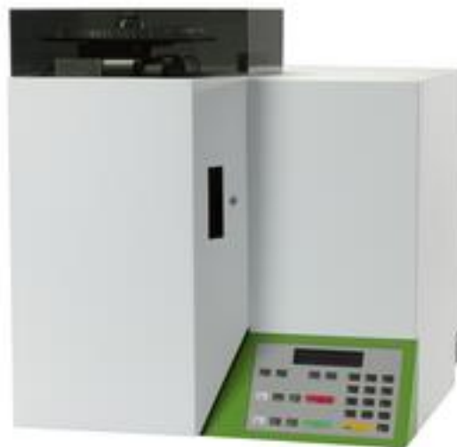
Рисунок 1 – Общий вид системы элементного CHNS/O анализа 2400
