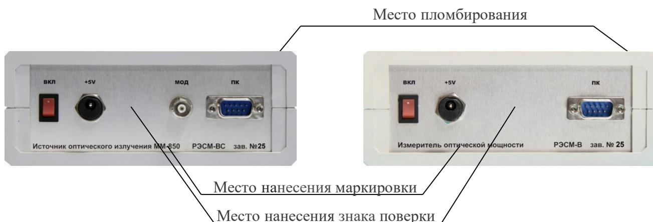
Рисунок 2 – Внешний вид источников и блоков измерителя оптической мощности РЭСМ-В со стороны задней панели
