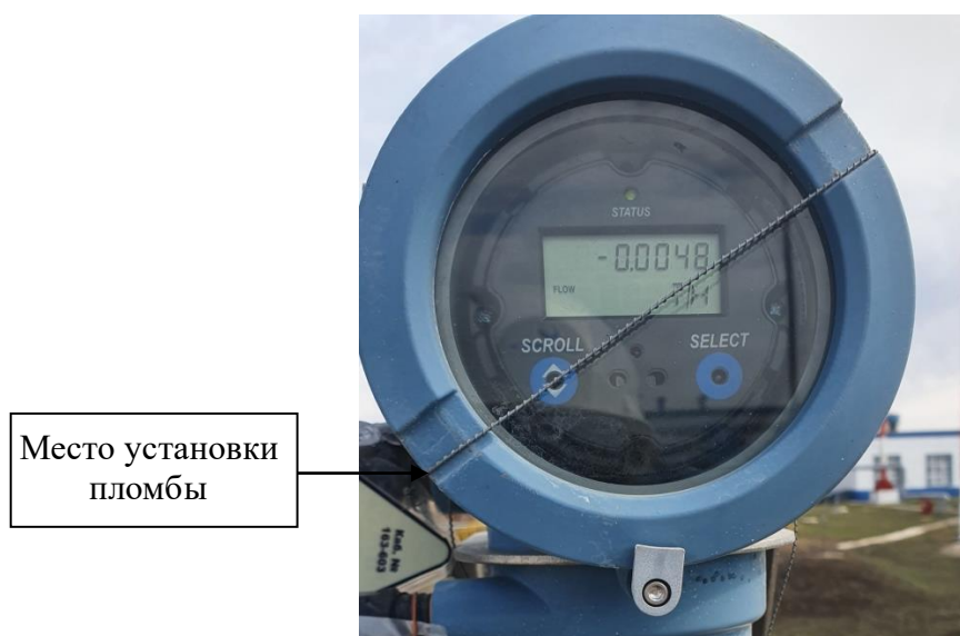
Рисунок 2 – Место установки пломбы для защиты от несанкционированного доступа электронного (измерительного) преобразователя СРМ.
