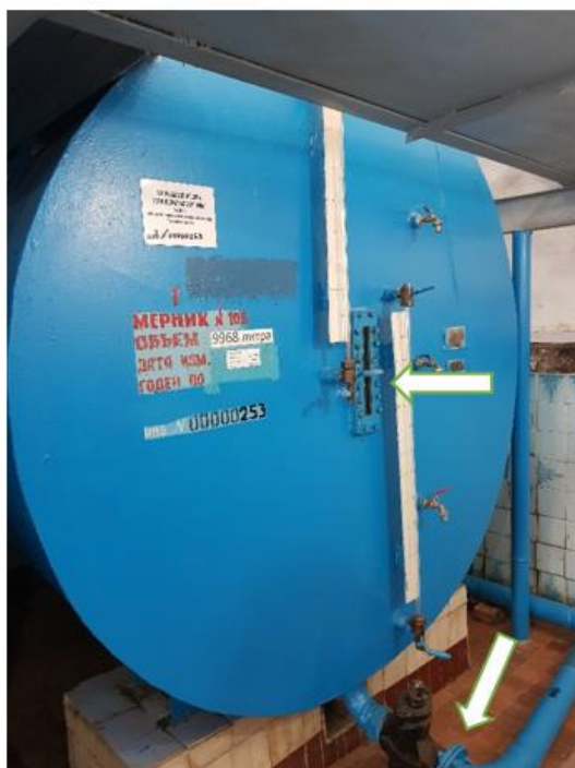
Рисунок 5 – Схема пломбировки мерника ММГ-1000У, зав.№ 60, от несанкционированного доступа, обозначение места нанесения знака поверки
