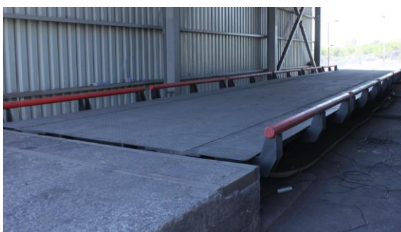
Рисунок 1 – Общий вид ГПУ весов, установленных на фундаментное основание
