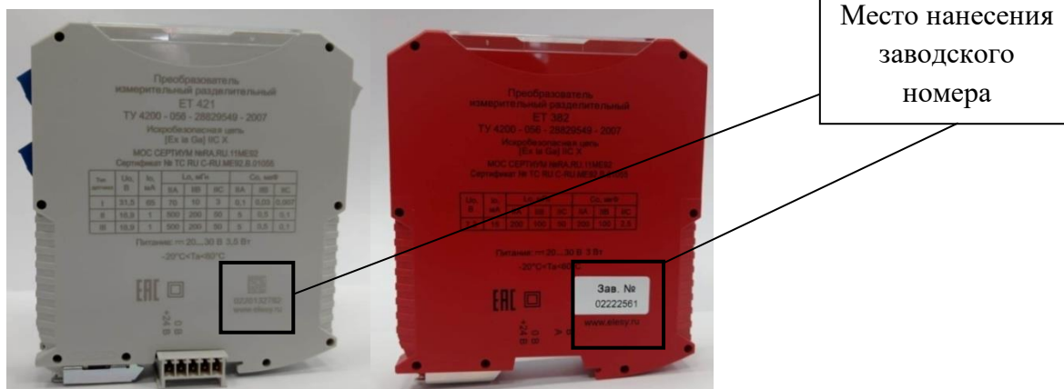
Рисунок 4 – Место нанесения заводского номера на преобразователи ET
