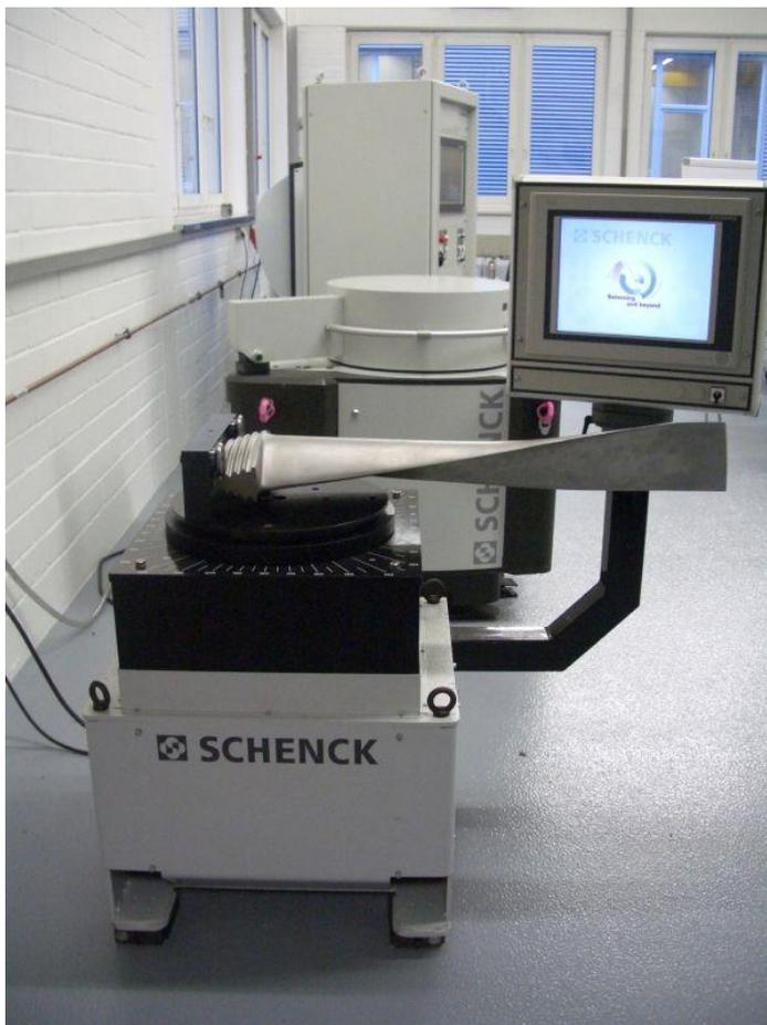
Рисунок 1 – Общий вид комплексов измерительных массы и статического момента WMEaero
