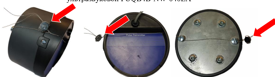
Рисунок 24 – Схема пломбирования или нанесения знака поверки на измеритель объема шестеренчатый OG-TI 200PVC
