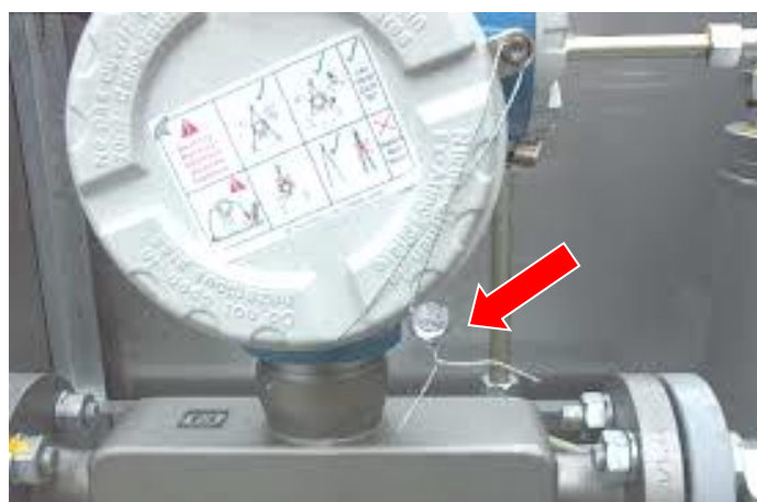
Рисунок 17 – Схема пломбирования или нанесения знака поверки на счетчики-расходомеры массовые Endres+Hauser Flowtec расходомеры массовые LPGmass
