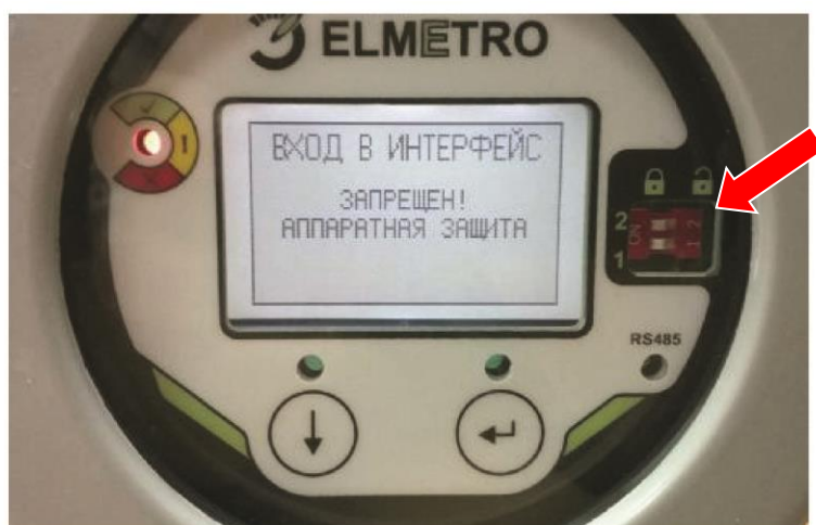
Рисунок 16 – Схема пломбирования или нанесения знака поверки на счетчики-расходомеры массовые ЭЛМЕТРО-Фломак
