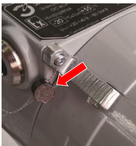
Рисунок 16 – Схема пломбирования или нанесения знака поверки на счетчики-расходомеры массовые ЭЛМЕТРО-Фломак
