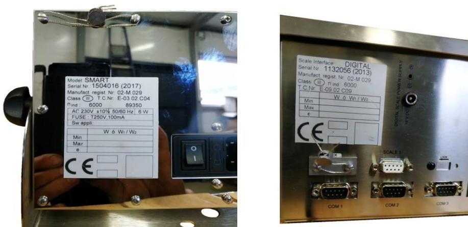
Рисунок 1 – Схема пломбировки индикаторов Smart и MATRIX II
