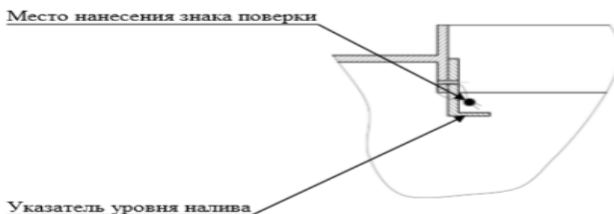
Рисунок 4 – Схема пломбировки указателя уровня топлива и место нанесения знака поверки
