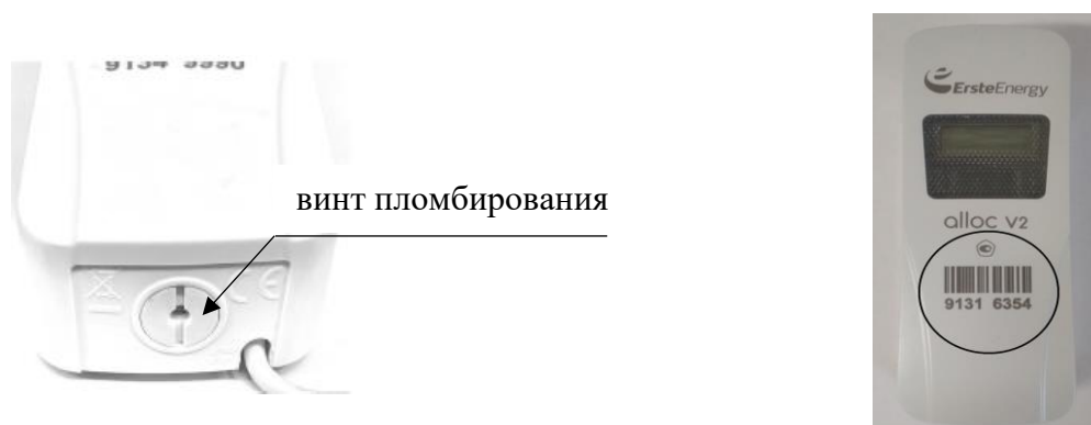
Рисунок 2 - Места пломбирования, знака утверждения типа, заводского номера, знака поверки
