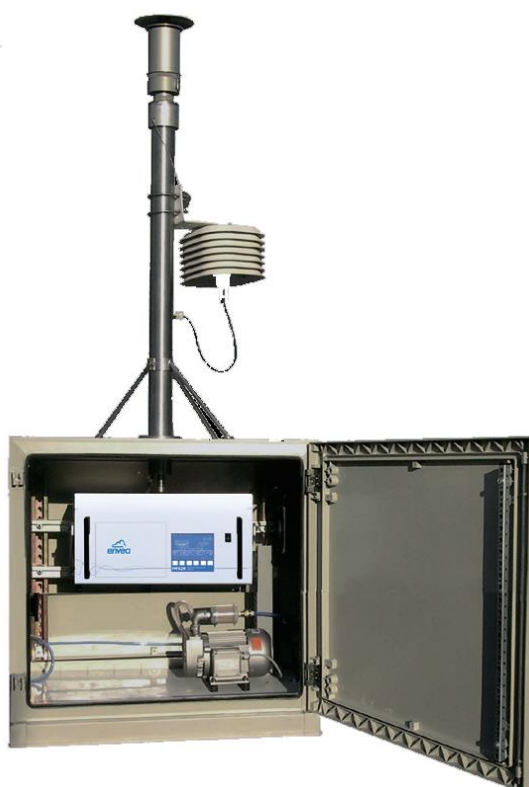
Рисунок 2 – Общий вид системы PM162M настенного исполнения, смонтированной в защитном шкафу
