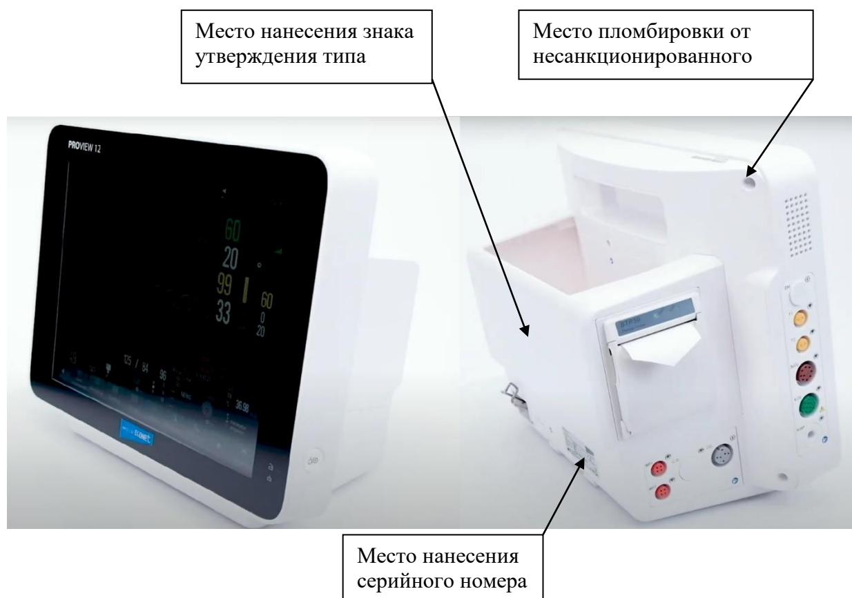
Рисунок 2 – Общий вид PROVIEW 12, схема пломбировки от несанкционированного доступа, место нанесения знака утверждения типа и место нанесения серийного номера
