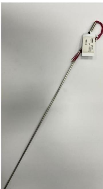
Рисунок 6 – Общий вид термопреобразователей модификаций TS-TC-M01, TS-TC-M02
