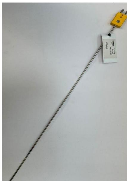
Рисунок 12 – Общий вид термопреобразователей модификаций TS-TC-FN, TS-CVO-TC-FN, TS-CNT-TC-FN, TS-EC-TC-FN, TS-IC-TC-FN, TS-NA-TC-FN
