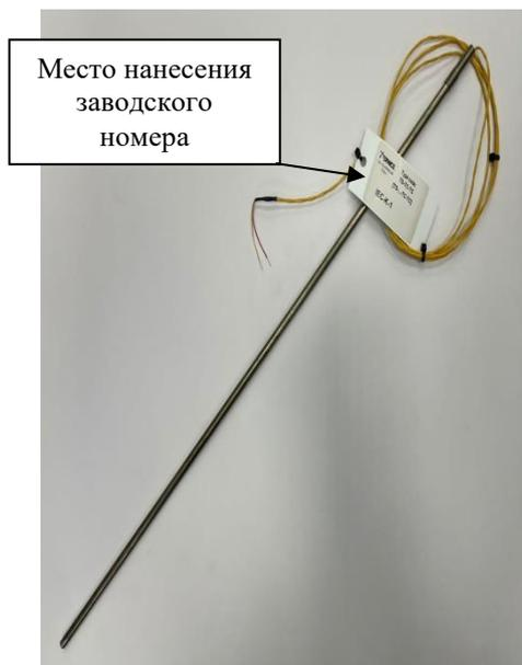
Рисунок 11 – Общий вид термопреобразователей модификаций TS-TC-TC, TS-CE-TC-TC, TS-CVO-TC-TC, TS-NA-TC-TC, TS-EC-TC-TC, TS-IC-TC-TC
