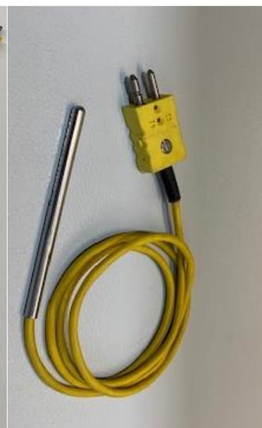
Рисунок 13 – Общий вид термопреобразователей модификаций TS-TC-CN, TS-EC-TC-CN, TS-IC-TC-CN
