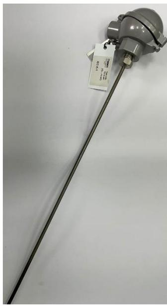
Рисунок 9 – Общий вид термопреобразователей модификации TS-TC-MT
