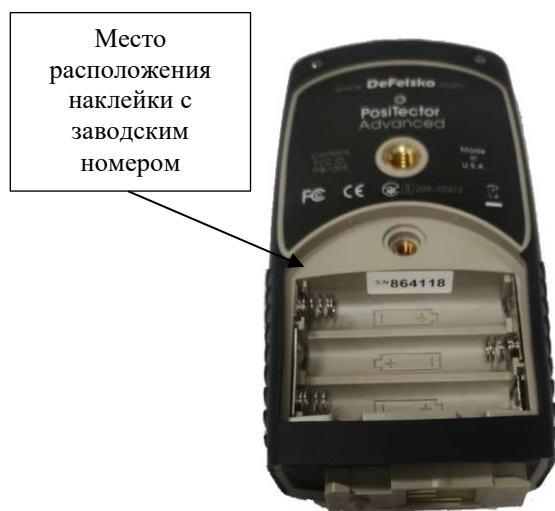
Рисунок 3 – Место расположения наклейки с заводским номером электронного блока
