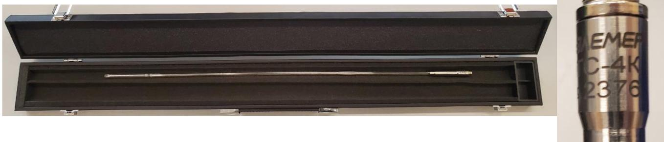
Рисунок 1 - Общий вид термометра сопротивления ВТС
