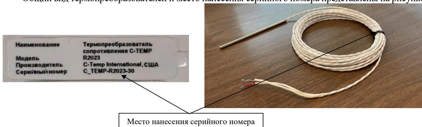
Рисунок 1 – Общий вид термопреобразователей и место нанесения серийного номера
