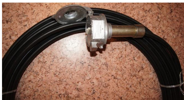
Рисунок 1 - Общий вид термоподвески ТП32
