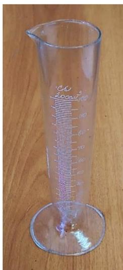
Рисунок 2 – Общий вид измерительного стакана осадкомеров О-1
