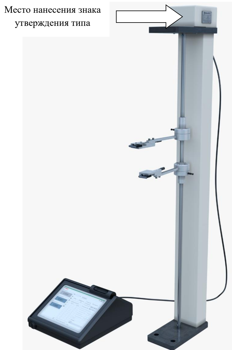
Рисунок 2 – Измерители перемещений (деформации) длинноходовые ИДК исполнений ИДК Д.В.С
