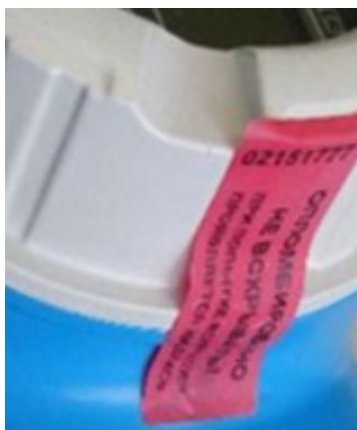
Рисунок 7 – Схема пломбирования корпуса преобразователей давления измерительных Cerabar с помощью наклейки.
