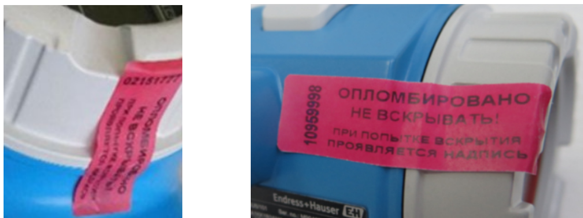
Рисунок 6 – Схема пломбирования корпуса преобразователей давления измерительных Deltabar с помощью наклейки.
