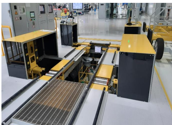
Рисунок 1 – Общий вид устройства для измерений углов установки колес автомобилей FORI FNCA-3DGT
