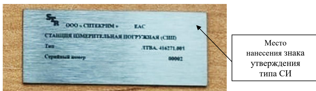
Рисунок 3 – Шильдик с указанием места знака утверждения типа СИ
