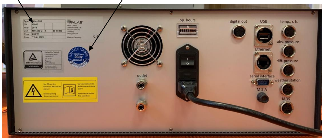
Рисунок 1 – Задняя панель анализаторов Fidas 200, Fidas 200 E, Fidas 200 S с указанием мест нанесения идентификационных данных, включая дату изготовления
