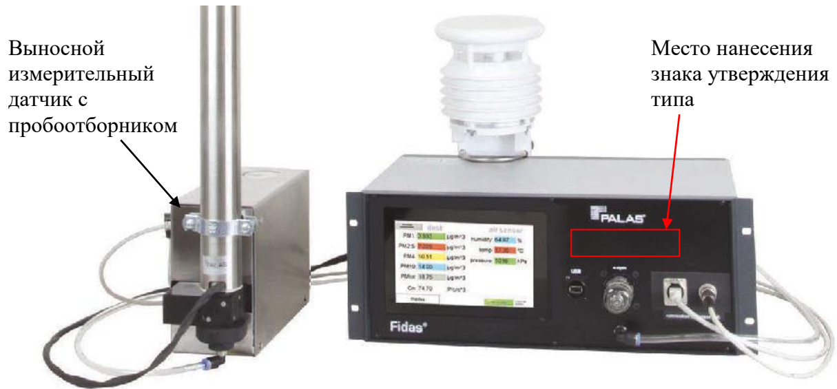
Рисунок 3 – Общий вид анализатора Fidas 200 E с выносным измерительным датчиком
